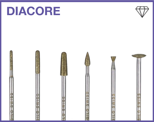
DIACORE Fraises diamantées dans la masse tailler et graver les pierres Gesinterte Diamant-Fraeser zum Steinschleifen- und Gravieren Diamond sintered burs for stones carving and engraving Sur tige standard Ø2.34mm 5'000-10'000rpm
